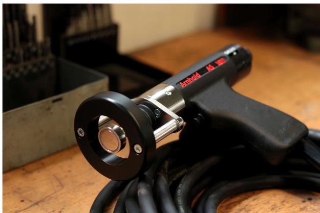
Die AS 1811 ist eine Kontakt-Spezialpistole für Isolieranwendung. Basierend auf der 1803D eignet sich diese Pistole hervorragend für das Verschweißen von Tellerstiften und Isoliernägeln. Das 10m lange Kabel ermöglicht zudem einen großen Arbeitsradius.
